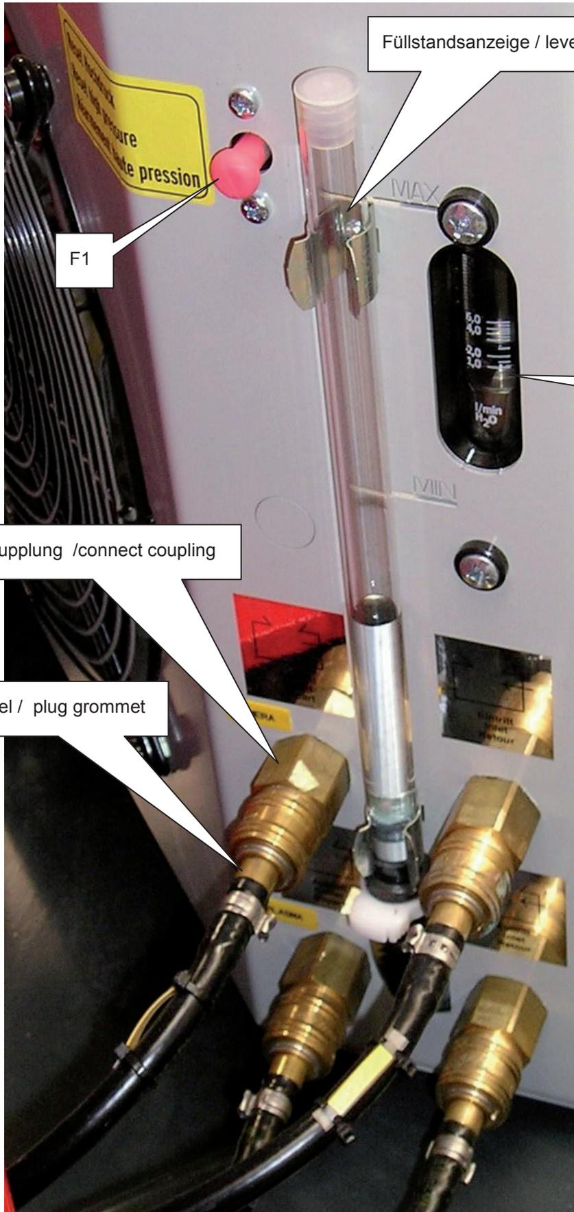
Füllstandsanzeige / level indicator
