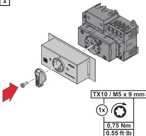
Remonter le couvercle du boîtier et le commutateur et les fixer à l'aide de la vis.
