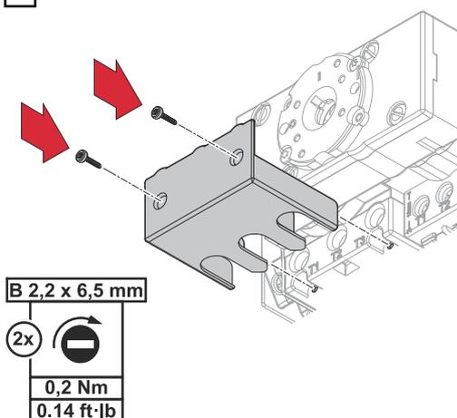
Monter un capot de protection en bas du sectionneur de charge 63 A. Pour le montage, utiliser les vis livrées.
