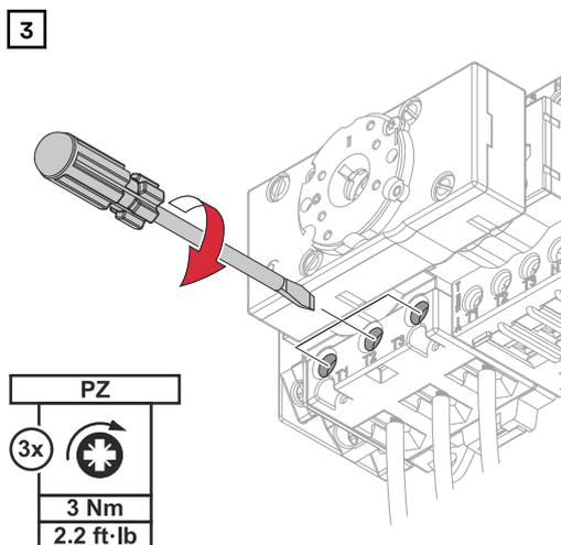
Visser les conducteurs uniques (L1', L2', L3') dans les bornes de raccordement. Pour les vis de raccordement et les couples de serrage autorisés, voir [Vis de raccordement autorisées](#) à la page [20](#).
