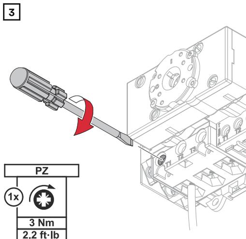
Visser le conducteur unique (L1') dans la borne de raccordement. Pour les vis de raccordement et les couples de serrage autorisés, voir [Vis de raccordement autorisées](#) à la page [20](#).
