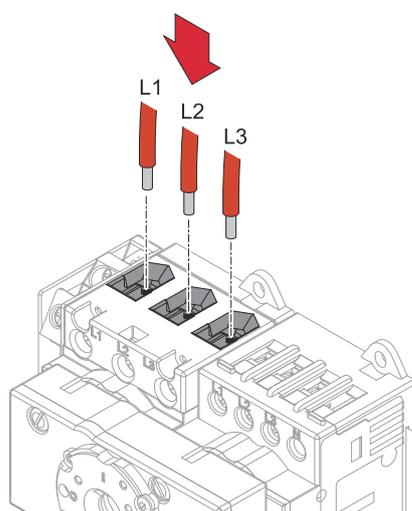
Insérer les conducteurs uniques (L1, L2, L3) provenant du réseau dans la borne de raccordement.
