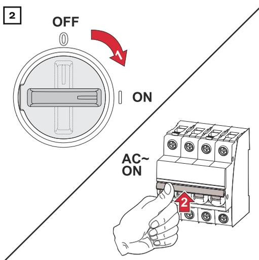
Placer le sectionneur DC en position « On ». Enclencher le système de protection automatique.
