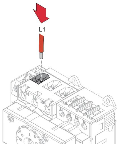
Insérer le conducteur unique (L1) provenant du réseau dans la borne de raccordement.
