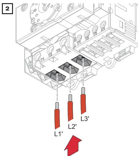
Brancher les conducteurs uniques (L1', L2', L3') provenant du circuit d'alimentation en courant de secours dans les bornes de raccordement.
