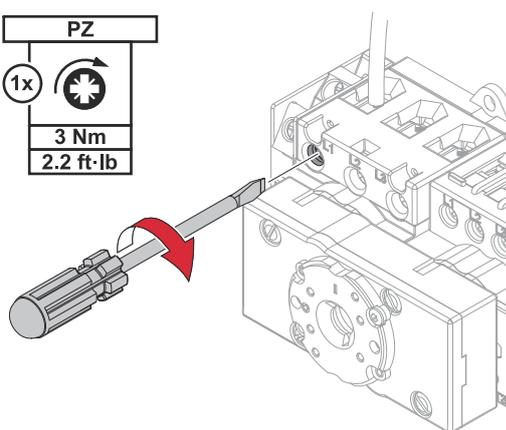
Visser le conducteur unique (L1) dans la borne de raccordement. Pour les vis de raccordement et les couples de serrage autorisés, voir [Vis de raccordement autorisées](#) à la page [20](#).
