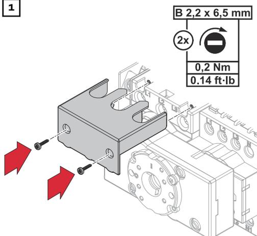
Monter un capot de protection sur le haut du sectionneur de charge 63 A. Pour le montage, utiliser les vis livrées.
