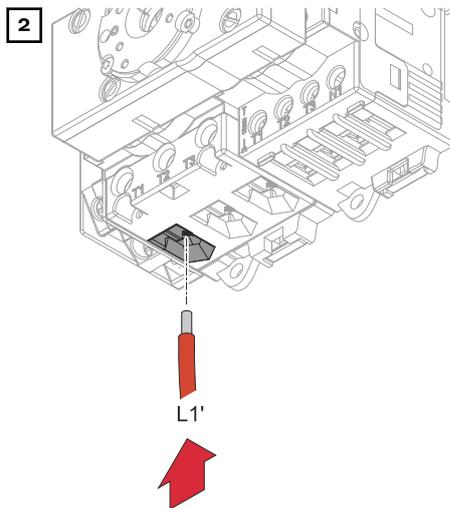
Insérer le conducteur unique (L1') provenant du circuit d'alimentation en courant de secours dans la borne de raccordement.
