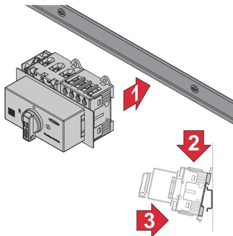
Le Fronius Backup Switch peut être monté sur un profilé chapeau DIN de 35 mm.
