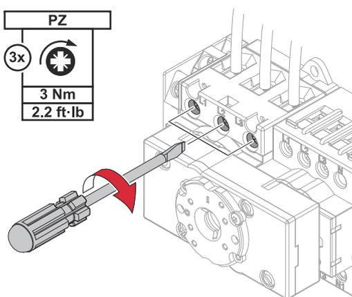
Visser les conducteurs uniques (L1, L2, L3) dans les bornes de raccordement. Pour les vis de raccordement et les couples de serrage autorisés, voir [Vis de raccordement autorisées](#) à la page [20](#).
