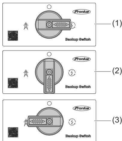
Le Backup Switch dispose de 3 positions de commutateur :
