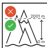
**IMPORTANTE!** Ohmpilot non deve essere montato e messo in funzione a un'altitudine superiore a 2.000 m.
