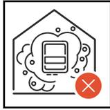
Non montare Ohmpilot in locali o ambienti in cui è presente molta polvere. Fondamentalmente Ohmpilot è realizzato a tenuta di polvere. Tuttavia, nelle aree che presentano forti accumuli di polvere, le superfici di raffreddamento possono impolverarsi compromettendo così l'efficienza termica. In questo caso è necessaria una pulizia a intervalli regolari.
