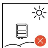
Per ridurre il più possibile il riscaldamento di Ohmpilot, non esporlo all'irraggiamento solare diretto. Montare Ohmpilot in una posizione riparata. Ohmpilot deve essere montato e messo in funzione solo a temperature ambiente comprese tra 0 e 40 °C.
