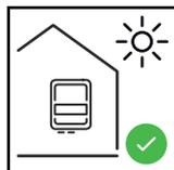
Ohmpilot è adatto all'installazione all'interno. L'alloggiamento soddisfa la classe di protezione IP 54 ed è protetto dagli spruzzi d'acqua su tutti i lati.
