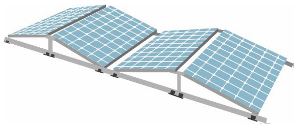
3. ábra: Kelet-nyugati rendszer lapostetőn való szerelési elrendezése
